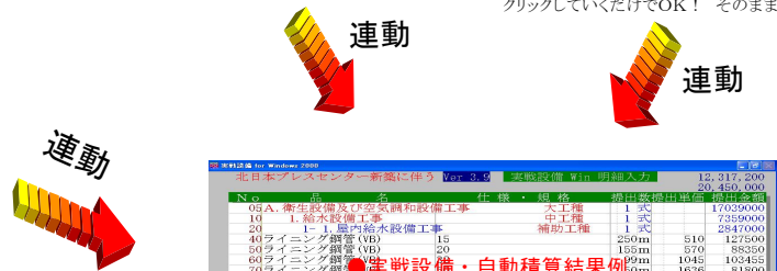
◎デジタイザに置いた図面の配管・配線の始点・終点をクリックしていくだけでOK! そのまま積算に連動します。
